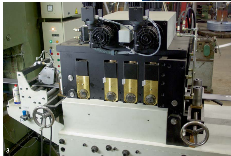
1 _ Die GSW Coilabroll-Vorschub-Richtmaschine bei Obermoser in Oderwitz ist lediglich sechs Meter lang.
