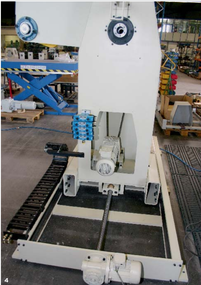
3 _ Leinhaas-Press mit interessanter Antriebslösung. (Bild: GSW Schwabe) 4 _ Haspel-Querverfäherung: Drehstrom-Motor und Spindel-element treiben dieses Handlings-system an. (Bild: N. Fecht)
