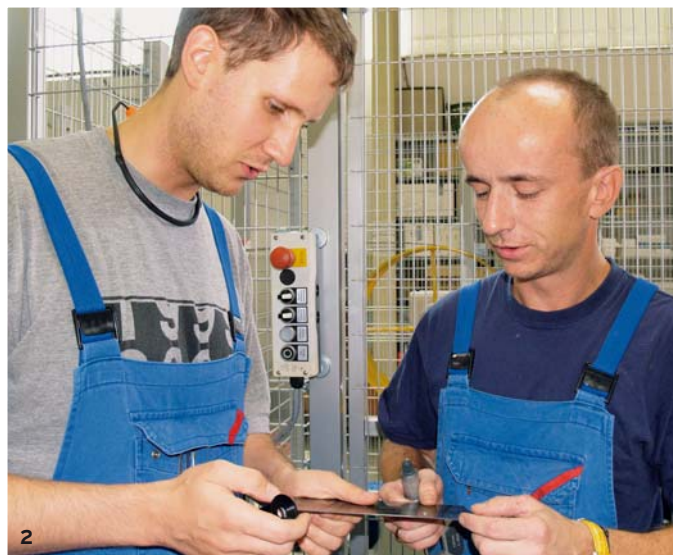
1 _ Detail der Ab- und Aufwickel-Coil-Anlage von GSW Schwabe beim Spezialisten für Streichklingen für die Papierindustrie Clouth Sprenger GmbH (während der Inbetriebnahmephase). 2 _ Die Anlagen-Bediener (von links) Daniel Lamers und Arne Gerhardt begutachten die Keramikbandkante eines Probestücks.
