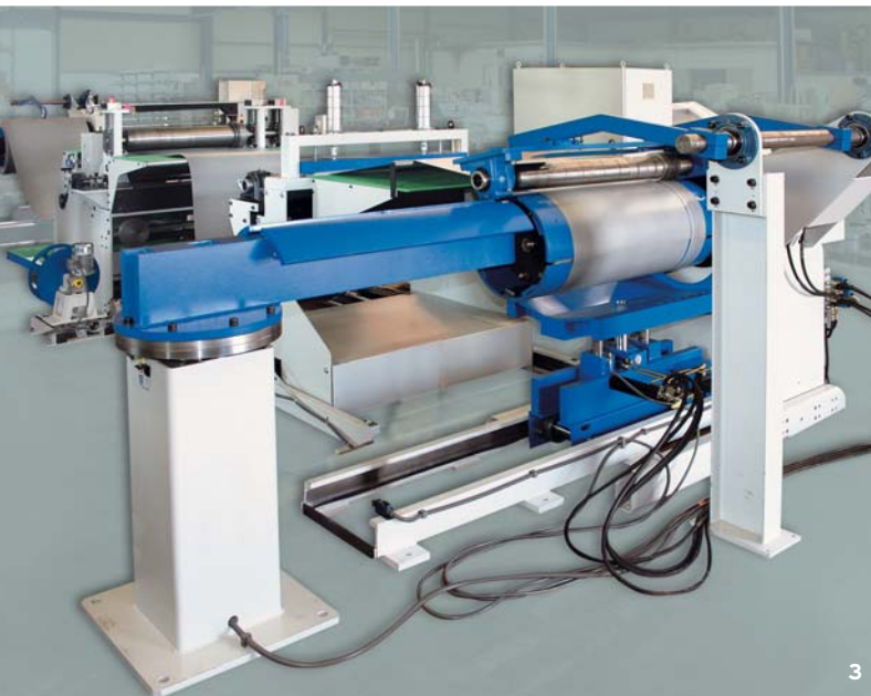
3 _ Gesamtansicht (vor Auslieferung) der Längsteilanlage, geliefert an einen Service-Konfektionierer für Trafobleche in Nordrhein-Westfalen für Bandbreiten bis 1.100 mm und Blechdicken von 0,27 bis 0,4 mm. 4 _ Detailansicht des Wickeldorns mit Separierscheiben und Abschiebeschild.
