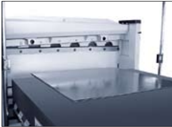
Abstapeleinheit mit Sensorsteuerung am Scherenausgang
